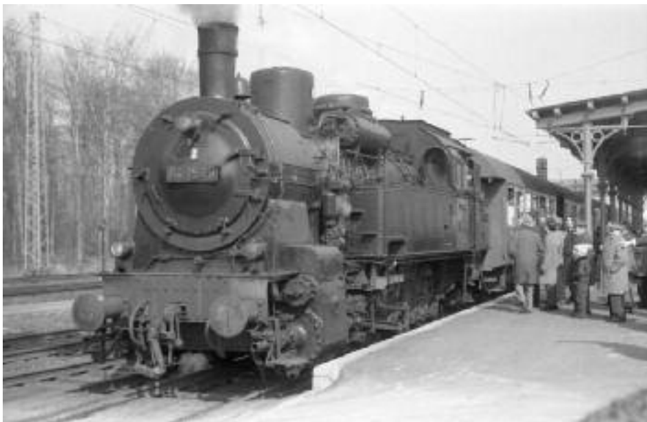
Am 22. März 1969 erreichte die DB 94 1588 mit einem von den „Freunden der Eisenbahn“ (Hamburg) veranstalteten Sonderzug den Bahnhof Haste. Beim Vergleich mit den Aufnahmen der 094 533 auf den vorangegangenen Seiten fällt auf, dass die Verkleidung des Dampfdoms oben deutlich weniger abgerundet ist – es ist schon erstaunlich, bei wie vielen Details es Variationen innerhalb einer Lokomotivbauart gab!
