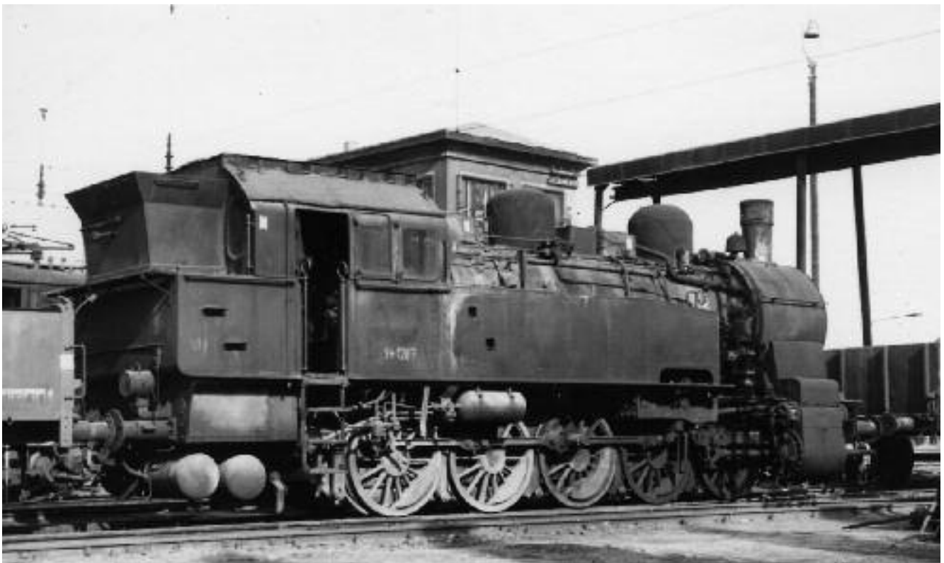
Die 94 1287 war nur in der Heizperiode 1968/69 bei der Großmarkthalle im Einsatz. Am 5. Juli 1969 – an diesen Tag entstand auch die obige Aufnahme – wurde die Lokomotive, bei der nur die Treibstange und einige Steuerungsteile fehlten, zum Verschrotten abgefahren. Der hinter dem Sandkasten auf dem Kesselscheitel sichtbare zweite Kasten diente übrigens zur Aufnahme von Dosiermittel und lässt sich sonst nur bei 94 584 und 94 1015 nachweisen. Foto: Wolfgang Müller
