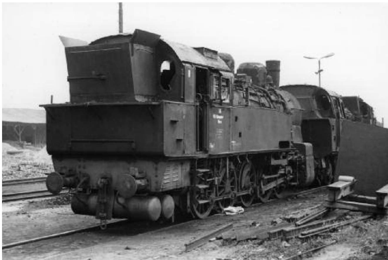
In einem traurigen Zustand mit bereits eingeschlagenen Scheiben befand sich am 5. Mai 1973 die Lok 26 des „VEB Kalikombinat Werra“ – so die Anschrift am Führerhaus. An der Lok auffällig sind die beiden gefasteten Domverkleidungen, die Lüftungsschlitze unter dem Kohlenkasten sowie die Form des Führerhausdaches.
