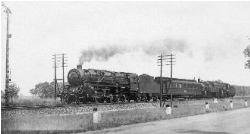
Im Juli 1933 wurde 44 012 messtechnisch untersucht – die Aufnahme zeigt sie mit den beiden Bremslokomotiven 94 1301 und 56 113 bei Brandenburg.
