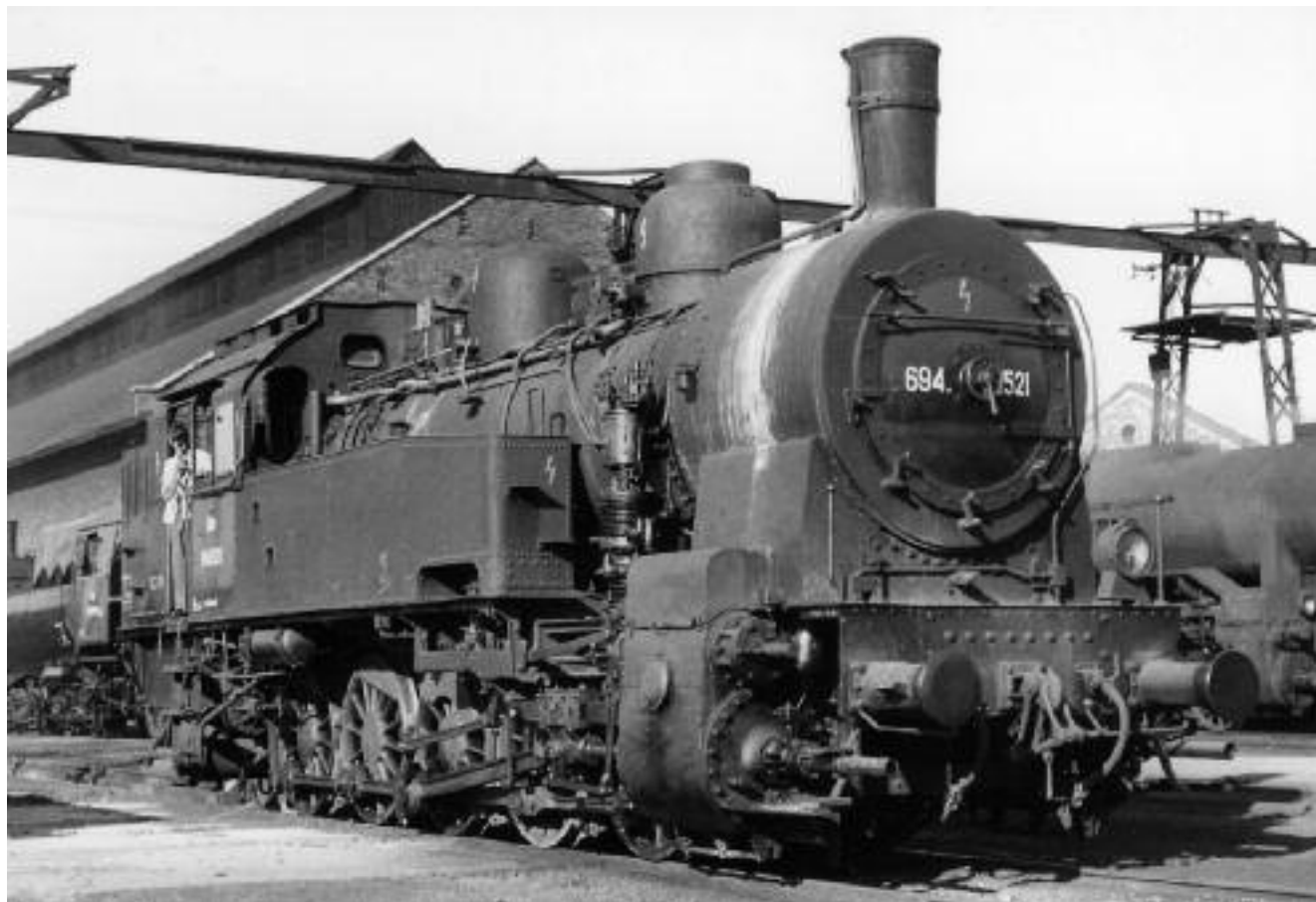
Im Jahr 1954, also kurz nach der 1953 angeordneten Umzeichnung von „94 1521“ in „694.1521“, wurde diese Maschine von Hellmuth Fröhlich in Wiener Neustadt fotografisch festgehalten. Auffällig ist der runde „Deckel“ auf dem Speisedom, der die kranzförmige Domdeckelverschraubung abdeckte. Foto: Archiv Helmut Griebel
