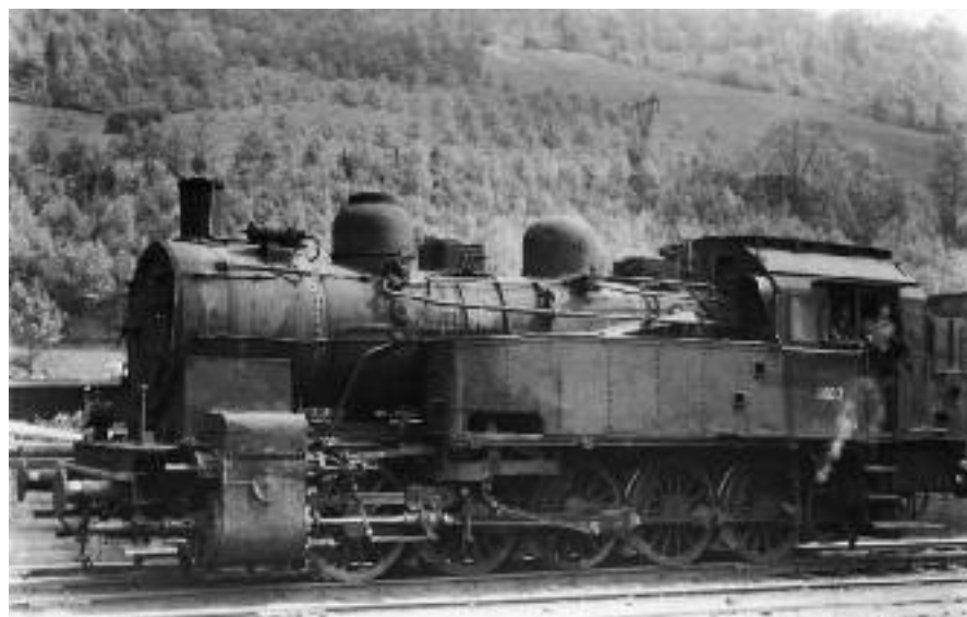
Als die Lok 1000.2 der Österreichisch-Alpinen Montangesellschaft im Jahr 1970 beim Rangieren in Donawitz fotografisch festgehalten wurde, besaß sie keinen Oberflächenvorwärmer mehr – eine interessante Parallele zu den im letzten Abschnitt besprochenen Lokomotiven der Monopol-Bergwerksgesellschaft. Den ungewöhnlichen Kranz auf dem Speisedom hatte die Maschine bereits zu ÖBB-Zeiten besessen.
